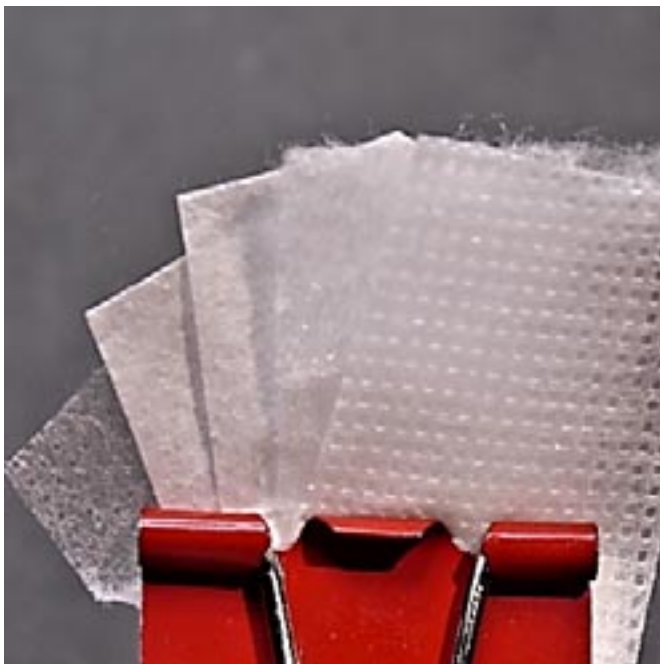
Figura 2: Mascherina professionale a 5 strati, ingrandimento fotografico di 1,5x, da sinistra a destra, strato di contatto con il viso, usualmente anallergico, due strati filtranti, molto compatti, uno strato lasso intermedio e infine a destra lo strato esterno che svolge funzione strutturale e di supporto. Il primo e l'ultimo strato sono lavorati con fibre sintetiche di diverso spessore in spunbond (la foto mette in evidenza dei piccoli quadratini trasparenti: sono i punti di presso-termofusione delle fibre, che così divengono strutturali); gli altri strati sono lavorati in meltblown.
