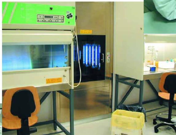
**Sinistra:** cappe a flusso laminare all'interno del Laboratorio Cellule Staminali, dedicate alla manipolazione delle cellule per uso trapiantologico. Tra le cappe si osserva il passbox UV ventilato che consente l'ingresso dei materiali provenienti dal Laboratorio Diagnosi
